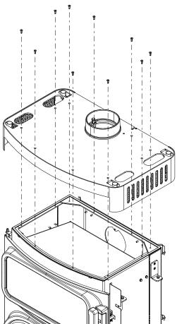
Fig. 49: Removing the lid
