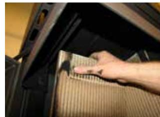
5. Haal het bovenste schot uit de kachel. U hebt nu vrije toegang voor het reinigen van de rookkanaalkamer boven de schotten.
