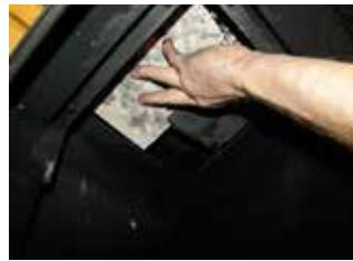
6. Avant d'allumer le poêle pour la première fois après un nettoyage, vérifiez que les deux déflecteurs et les briques latérales sont correctement installés. Refaites cela en ordre inverse pour démonter ces composants.
