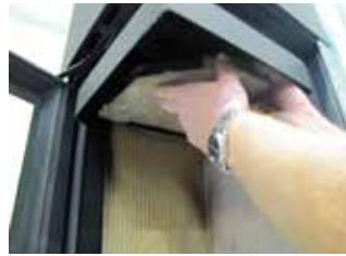
3. Ensuite sortez le raccord d'angle sur lequel le déflecteur inférieur repose. Ce raccord sert aussi à maintenir les briques latérales en place.
