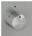
Schnelle Verbrennung: Primärluftregler geöffnet (ganz nach rechts)
