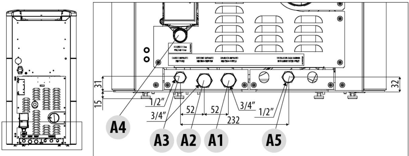
**Fig. 59 - Connection diagram DHW**
