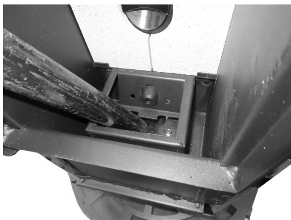
Fig. 22 - Reiniging ruimte vuurpot
