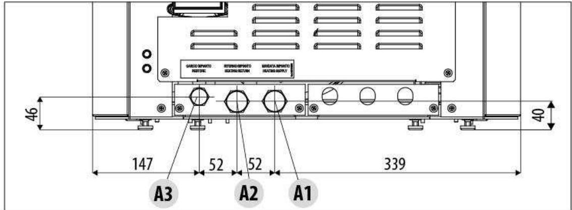
A1 = Wasservorlauf Heizung 3/4" M
