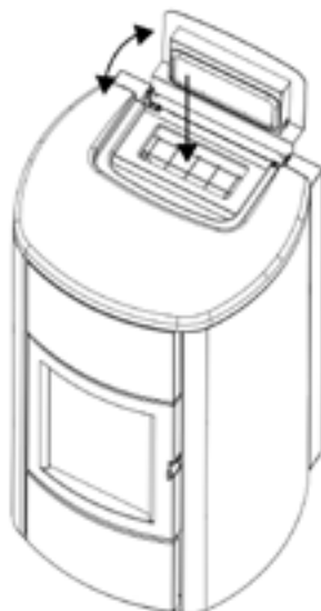
Fig. 38 - De pellets laden
