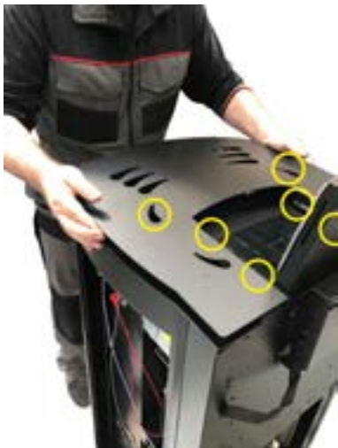
Fig. 28 - Verwijdering van de afdekking
