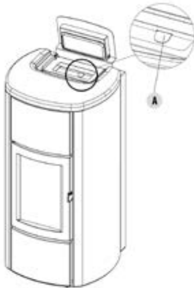
Fig. 64 - Hendel voor reiniging turbolatoren (Idro Prince 3 16-23-23 H2O, Aquos 3 16-23-23 H2O, Idron 16-22 Airtight, Hidrofire 22.8)
